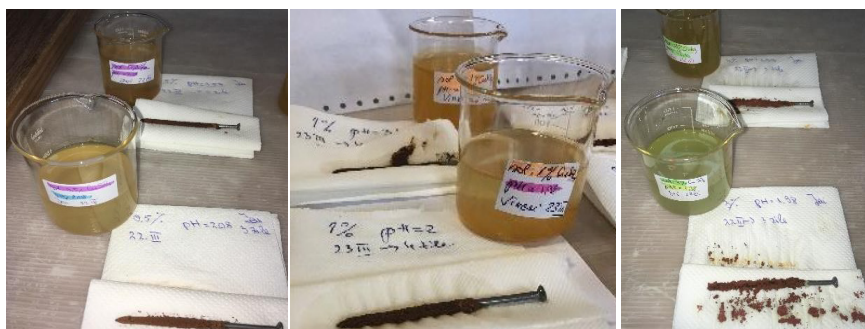
Fig. 4. The amount of copper powder obtained after one day of experiment Rys. 4. Ilość proszku miedzi uzyskanego po jednym dniu doświadczenia
