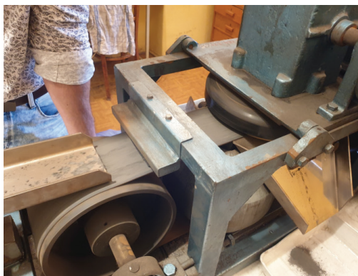
Rys. 12. Separator magnetyczny – podajnik wibracyjny materiału Fig. 12. Magnetic separator – material vibrating feeder
