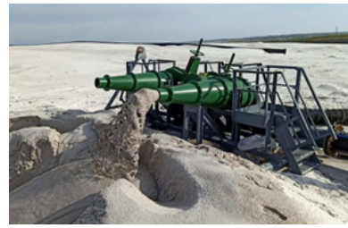
Fig. 3. Release of tailings from hydrocyclones Rys. 3. Zrzut odpadów poflotacyjnych z hydrocyklonów
