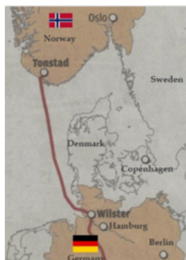
Fig. 1. NordLink power cable [15]
