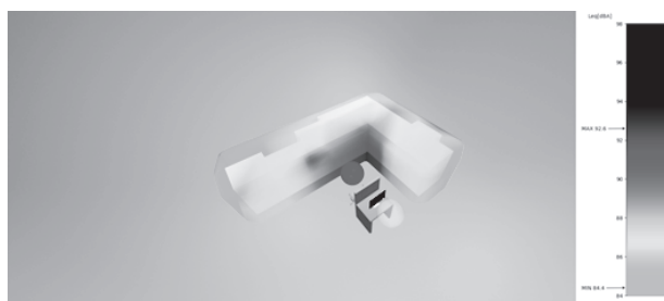
Rys. 1. Przykładowa strefa ciszy oraz wskazanie źródeł hałasu wokół maszyny. Źródło: opracowanie własne Fig. 1. Example of a quiet zone and indication of noise sources around the machine. Source: own study
