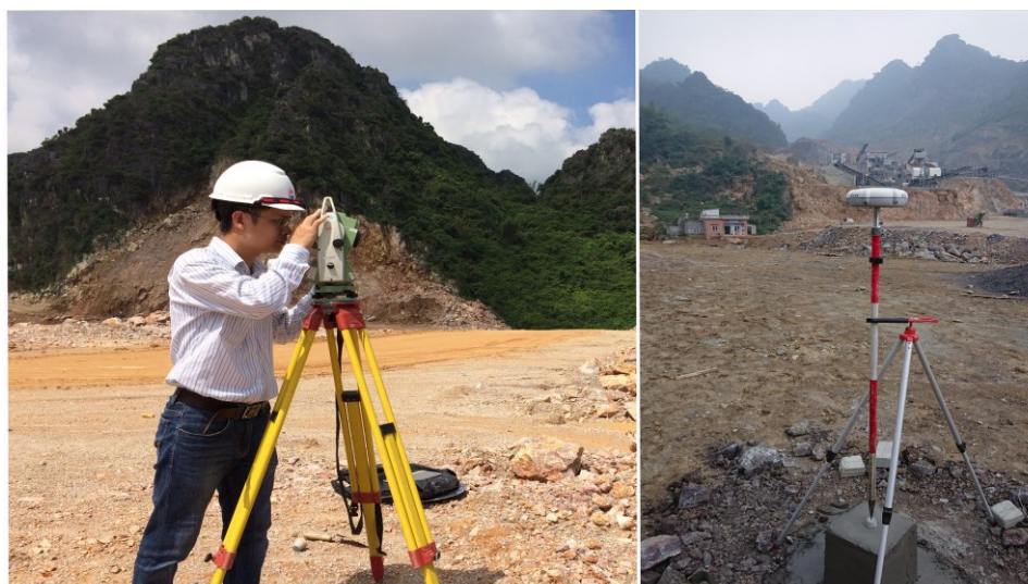
Fig 4. Observing GCPs and check points using the GNSS and total station. Rys. 4. Ustanowienie punktów kontroli naziemnej za pomocą metod GNSS i tachimetru
