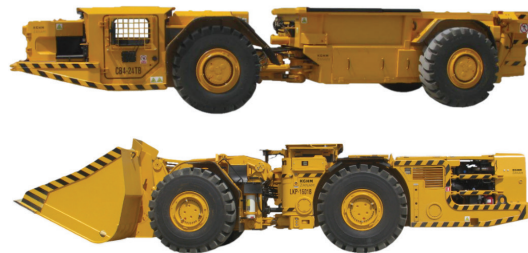
Rys. 3. Wóz odstawczy CB4-24TB oraz ładowarka LKP-1601B produkcji KGHM ZANAM [6] Fig. 3. Haul truck CB4-24TB and loader LKP-1601B manufactured by KGHM ZANAM [6]
