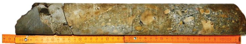
Rys. 7. Widok rdzenia pobranego z obmurza szybu w rejonie poziomiu II Fig. 7. Core taken from the shaft lining at the level II
