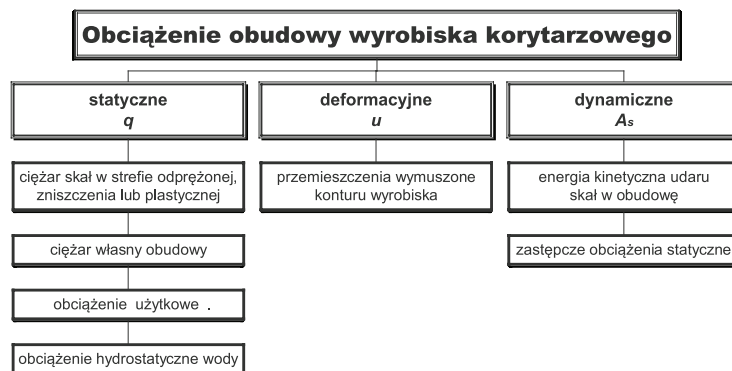
Rys. 1. Rodzaje obciążenia obudowy wyrobisk korytarzowych i komorowych [1,5,7]
