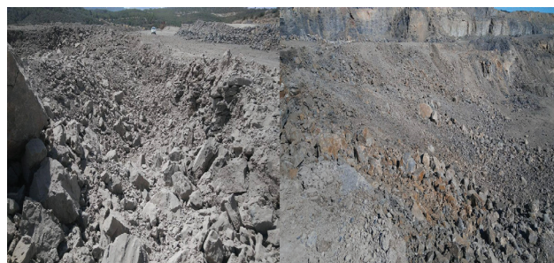
Fig. 5. Blasting results for doubled and simples holes Rys. 5. Wyniki strzelania otworami pojedynczymi i podwójnymi
