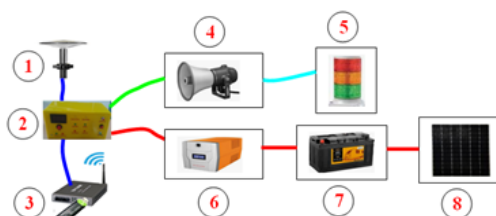
Fig. 10. Diagram of device connection at a monitoring station Rys. 10. Schemat podłączenia urządzenia na stacji monitorującej
