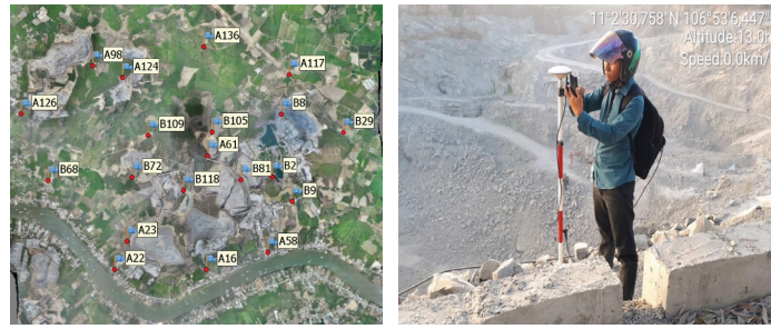
Fig. 5. Subsidence measurement by GNSS Rys. 5. Pomiar osiadania metodą GNSS
