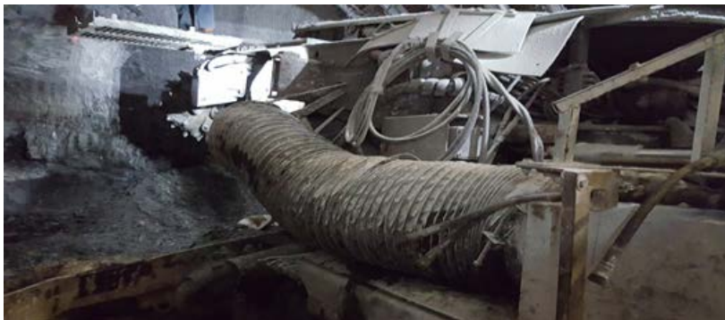
Rys. 5. Widok zabudowy ssawy z lewej strony kombajnu chodnikowego DH R75TH [1]
