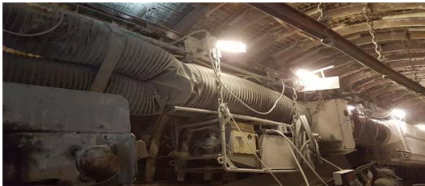
Rys. 4. Trójnik wentylacyjny 800/500 mm wchodzący w skład instalacji odpylającej [1]
