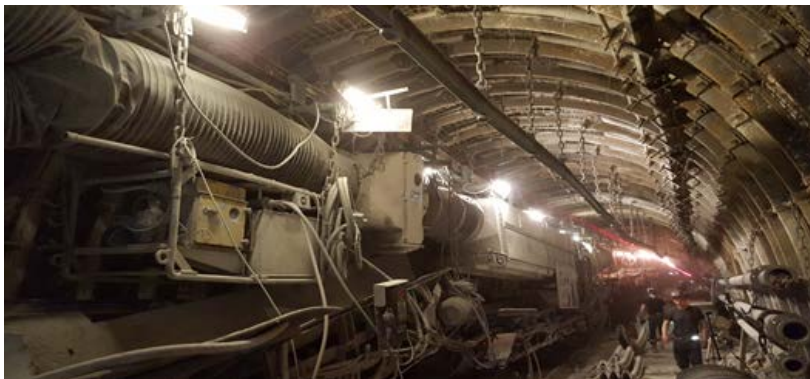
Rys. 3. Widok suchego odpylacza powietrz HBKO 1/500 firmy CFT w strefie przodkowej [1]
