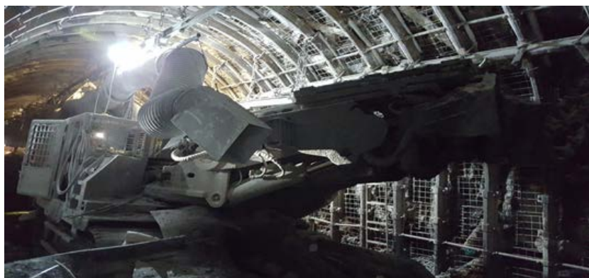
Rys. 6. Widok ssawy z prawej strony kombajnu DH R75TH po modyfikacji jej wylotu [1]
