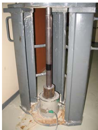
Rys. 4. Stanowisko do badania siły działania i temperatury reakcji
