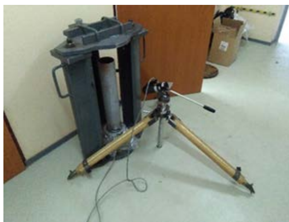
Rys. 4. Stanowisko do badania siły działania i temperatury reakcji
