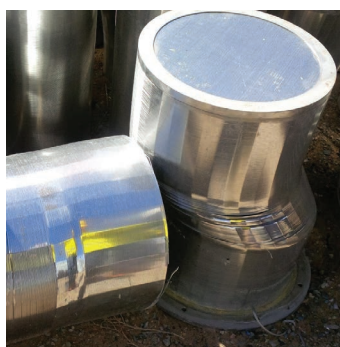
Rys. 22. Uszkodzony filtr kolumny SNK
