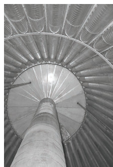
Rys. 18. Reaktory do reformingu ropy z zabudowanymi sitami szczelinowymi
