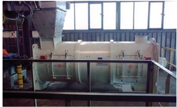
Fot. 2. Granulator mułów WAH w ZG „Sobieski”
