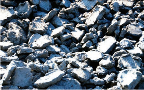
Fot. 1. Placki mułowe z pras filtracyjnych
