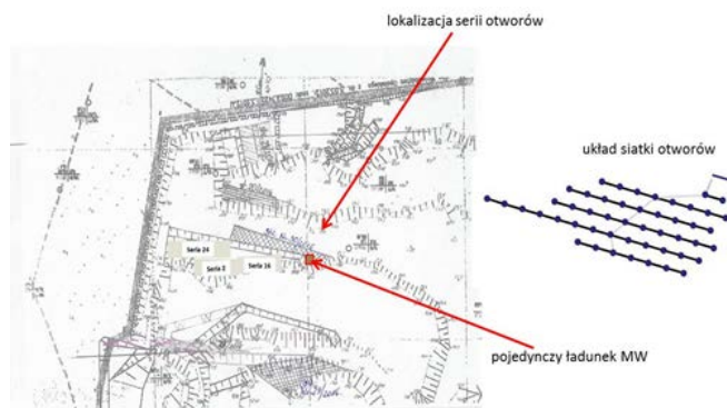
Rys. 2. Lokalizacja i układ projektowanej serii otworów, miejsce odpalenia pojedynczego ładunku MW
