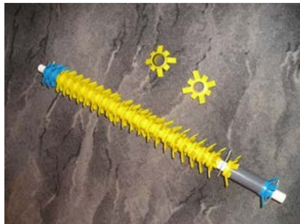
Rys. 3. Kotwiczki magnetyczne sondy ekstensometrycznej SRS Fig. 3. Anchors of sonic extensometer
