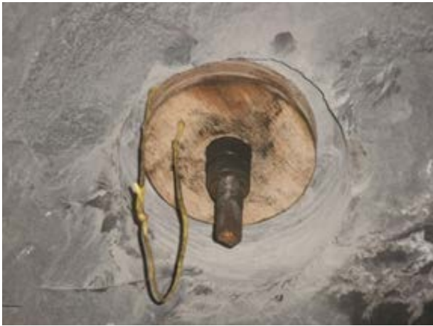
Rys. 2. Wskaźnik rozwarstwień stropu SRS Fig.2. Fast separation indicator SRS
