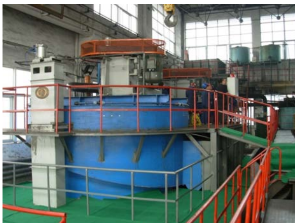
Jeden z dwóch flotowników typu IF-45 zainstalowanych w kopalni węgla Bailong w ChRL.
