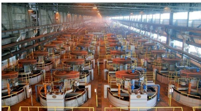
Maszyny flotacyjne typu IF-57 zainstalowane w kopalni Rudna KGHM Polska Miedź SA
