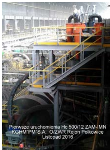
Bateria hydrocyklonów HC500/12 ZAM-IMN.
