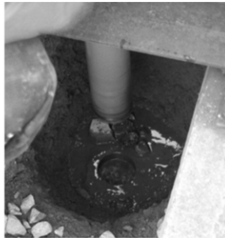
Fig. 1. The core drilling performed with the drill stand in 2005: a) the drilling rig; b) the low depth borehole Rys. 1. Wiercenie rdzenia w 2005 roku a) urządzenie wiertnicze; b) płytki otwór
