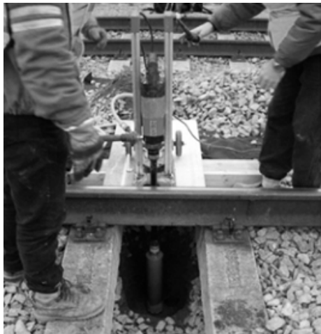
Fig. 1. The core drilling performed with the drill stand in 2005: a) the drilling rig; b) the low depth borehole Rys. 1. Wiercenie rdzenia w 2005 roku a) urządzenie wiertnicze; b) płytki otwór
