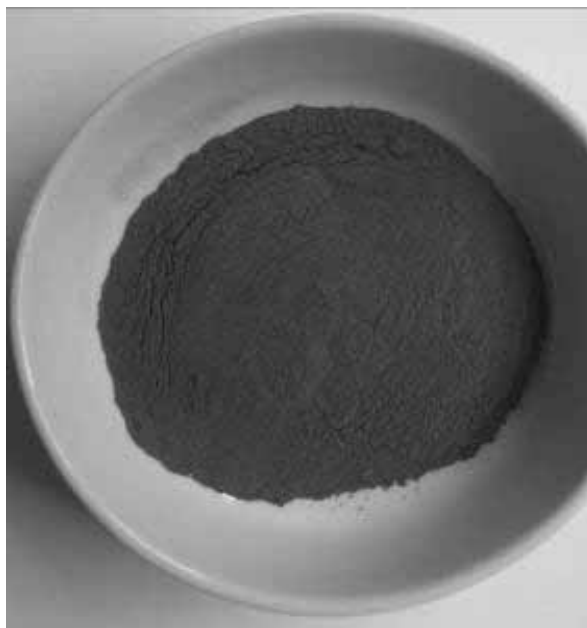
Rys. 3 Widok popiołu z odpadów komunalnych Krakowa
