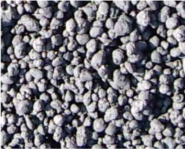
Rys. 2 Wygląd granulowanych mułów węglowych z udziałem popiołu fluidalnego
