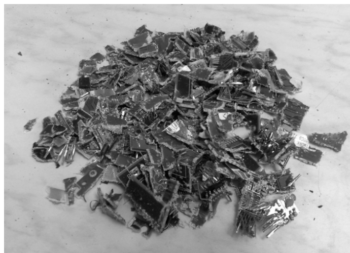
Rys. 2 Rozdrobnione i ujednorodnione odpady elektroniczne przygotowane do procesu ługowania
