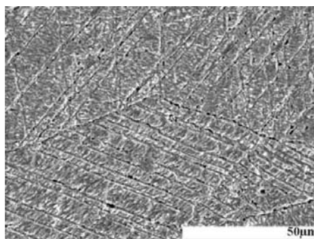
Rys. 14 Obraz z mikroskopu elektronicznego wytrawionych kształtów (refleksy struktury kratowej) na powierzchni stibnitru po 10 dniach ługowania chemicznego
