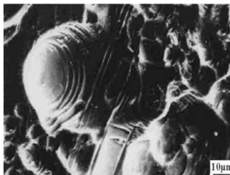
Rys. 11 Koncentryczne linie kulistego kształtu na powierzchni rodzimego antymonu po 18 dniach ługowania biologiczno-chemicznego. Obraz z mikroskopu elektronowego
