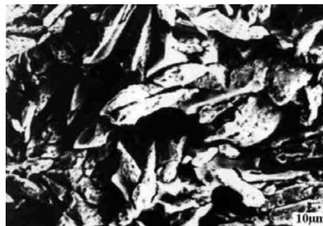
Rys. 4 Euhedralne kryształy agregatów lelingitu po 14 dniach ługowania biologiczno-chemicznego. Obraz z mikroskopu elektronowego
